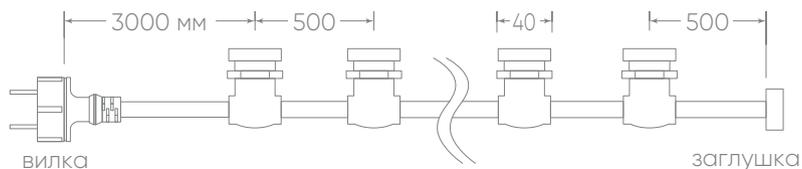
Соединение в линию максимальной мощностью 3680 W.
