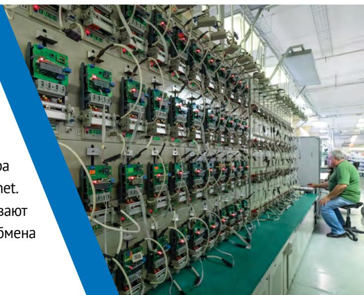
Компания постоянно совершенствуется, внедряются технологии, позволяющие эффективно бороться с фальсификацией показаний. Счетчики имеют электронные пломбы, неразборные корпуса, два измерительных элемента, многоуровневую систему паролей, уникальные номерные заводские пломбы.
