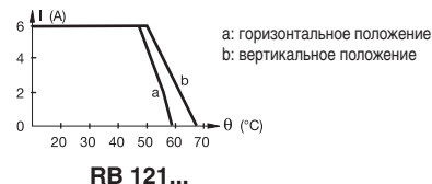
Кривая снижения номинальных параметров
