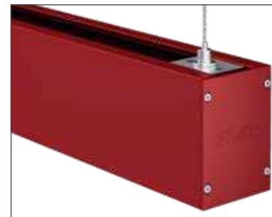
После покраски светильника в цвет, выбранный заказчиком, дополнительно меняются торцевые крышки на металлические, также окрашенные в цвет корпуса, устанавливаются специальные винты в потай.
