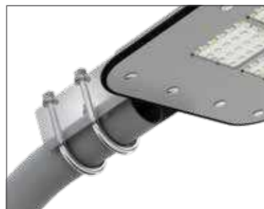
Светильники оснащаются надежным консольным крепежом, для монтажа на опоры диаметром до 48 мм
