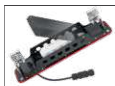
Замена источника питания без демонтажа светильника
