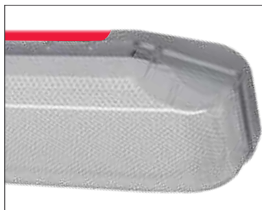
Для исключения перегрева электронных компонентов в корпусе сделаны тепловые зазоры
