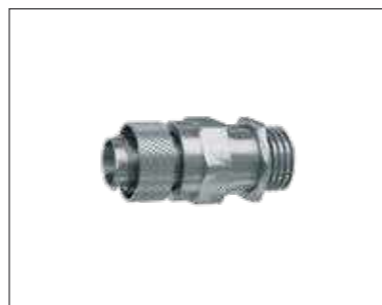
Кабельный ввод под металлорукав КНВМ2М-20.../Р, M25 d=6-17, D рукав = 28 мм
