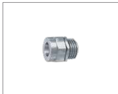
Кабельный ввод под небронированный кабель КНВ2М.../Р, M25 диаметр обжимаемого провода 6-18 мм
