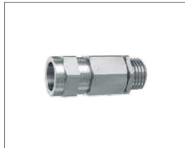
Кабельный ввод под бронированный кабель M25 d=6-18, D = 9-25 мм
