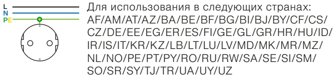
Рис. 1. Розетка SCHUKO* с 2 полюсами + заземление, 250 В ~ , 16 А
