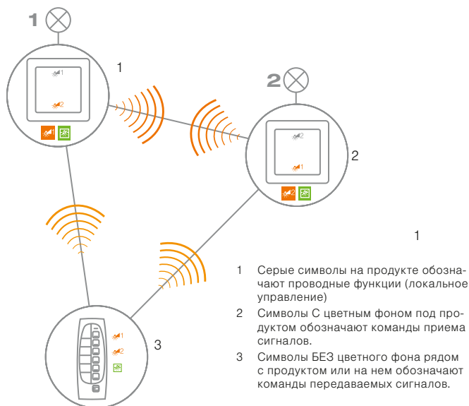
Рис 3: Пример конфигурации передатчик/приемник
