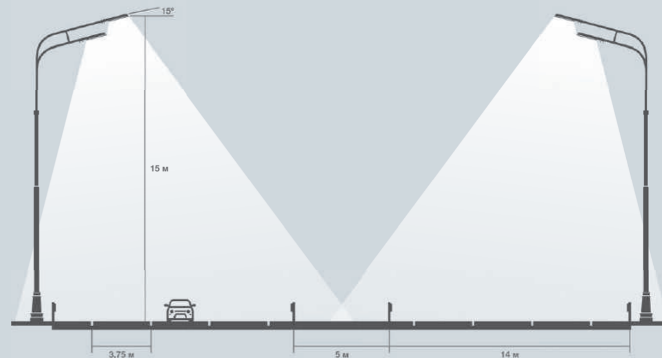
Расположение светильников над дорожным полотном
