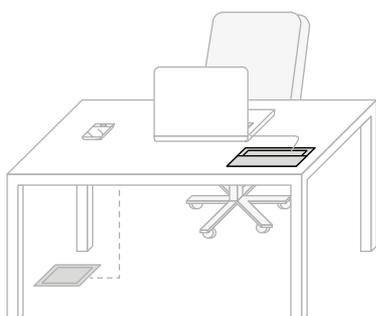
Комплект изделий, встраиваемых в стол, под разводку кабелей в мебели. Состоит из 1 двойного зарядного устройства USB, 3 розеток 230 В и 1 отверстия под установку 1 модуля для 2 разъемов RJ45. Кабель подключается к 3-контактному быстроразъемному соединению стандарта GST18 и электрической распределительной панели, либо к напольному люку с помощью одного соединительного шнура.
