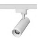
Мощность: 20 Вт; Световой поток: 1350 лм; Цветовая температура: 3000 К; Угол рассеивания: 15-55°; Светодиоды: СОВ; Размеры: 220ר70 мм; Материал: пластик+алюминий
