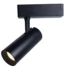
Мощность: 10 Вт; Световой поток: 700 лм; Цветовая температура: 4000 К; Угол рассеивания: 24°; Светодиоды: СОВ; Размеры: 54×120×109 мм; Материал: пластик+алюминий
