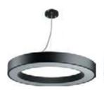
Б0050563 SP0-133-B-40K-045 Мощность: 45 Вт; Световой поток: 3200 лм; Размеры:
