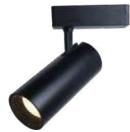
Мощность: 20 Вт; Световой поток: 1400 лм; Цветовая температура: 4000 К; Угол рассеивания: 24°; Светодиоды: СОВ; Размеры: 68×160×118 мм; Материал: пластик-алюминий
