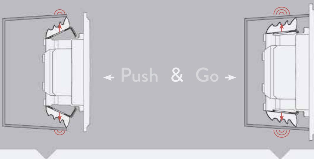
По мере нажима зубцы сжимаются и обеспечивают фиксацию в установочной коробке.
