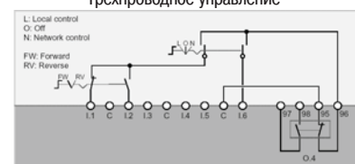
Схема с однокнопочным местным управлением и сетевым разрешением пуска Двухпроводное управление
