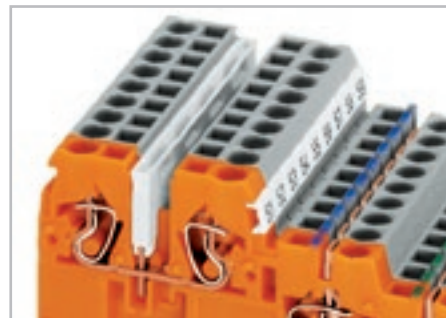
Объединение по напряжению уровня сигнала с помощью изолированных гребешковых перемычек серии 870, 2-... 9-контактов, в зависимости от применения. Клеммы для датчиков со светодиодом не могут быть объединены по уровню сигнала.
