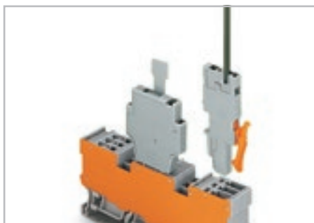
1-проводная/1-контактная базовая клемма с 2 позициями для перемычек 1-проводная розетка, прямая* Штекерный предохранитель шириной 6 мм (каждая вторая клемма)
