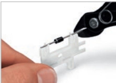
Обрезка компонента до необходимой длины.
