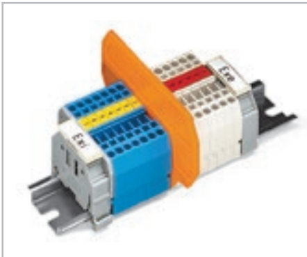
Разделительная перегородка для применений с уровнями взрывозащиты Ex e / Ex i Согласно EN 50020, между находящимися под напряжением деталями цепей Ex e и Ex i должна соблюдаться дистанция в 50 мм. Использование разделителей Ex e / Ex i позволяет сэкономить место, когда клеммы Ex e и Ex i монтируются на обычную несущую рейку. Подходит для клемм серии 279 ... 282. 209-190 для 2-проводных клемм 209-191 для 2-, 3-, 4-проводных клемм.
