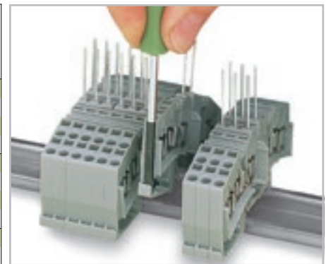
Удаление: отделите клеммную колодку, выдвиньте клемму, чтобы разъединить ее, а затем снять с рельса.
