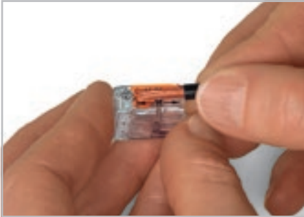
Зачистите изоляцию на длину 11 мм.
