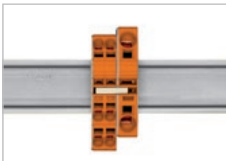
Объединение с использованием гребешковых перемычек Объединение через открытую сторону клеммы с торцевой пластиной позволяет использовать перемычки больше двух поперечных размеров для 16 мм 2 /AWG 6 и 10 мм 2 /AWG 8 и больше одного размера для 6/4/2,5 мм 2 (AWG 10/12/14); напр., от 16 мм 2 /AWG 6 до 6 мм 2 /AWG 10 (см. рисунок выше) или от 10 мм 2 /AWG 8 до 4 мм 2 /AWG 12.
