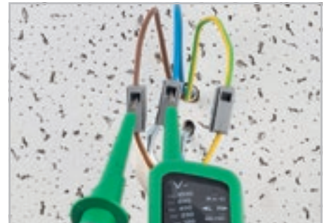
Измерение через отдельное тестовое гнездо.
