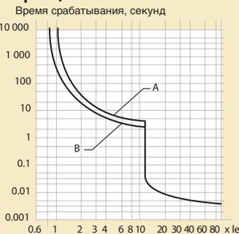
График приведен для срабатывания в холодном состоянии. Чтобы получить время срабатывания в нагретом состоянии, умножьте найденное по графику значение на 0,75.
