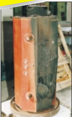
Катушка трансформатора Trihal после испытания F1
