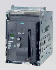
Выкатной, 3-полюсный, размер I (горизонт. присоедиенение) In=1000A, Icu(Ics)=66кA, расц. ETU35WT, функции LSI
