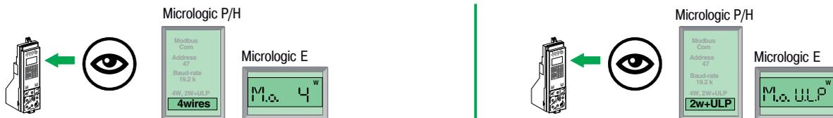
**A** Modbus RS 485 (4 провода) без модуля ULP
