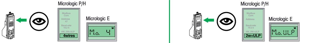
**A** Modbus RS 485 (4 провода) без модуля ULP
