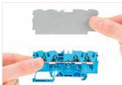
Разделительная перегородка для применений с уровнями взрывозащиты Ex e / Ex i Торцевая пластина должна устанавливаться на клемму, расположенную сразу за разделительной перегородкой Ex e/Ex i
