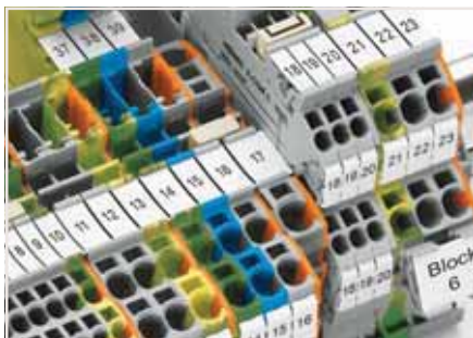
Объединение клемм X-COM®S-SYSTEM с помощью перемычек для клемм TOPJOB® S. Торцевая пластина обеспечивает соединение с клеммами TOPJOB® S. Клеммы серий 2020 и 2022 могут комбинироваться друг с другом. Гнёзда для перемычек находятся на одном и том же уровне для обеих серий.
