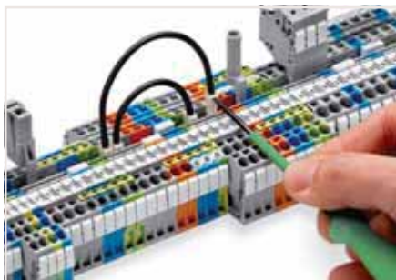
Установите вставную проводную перемычку до упора. Поднимите перемычку с помощью рабочего инструмента для повторного монтажа
