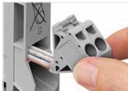
Надёжный и простой отвод напряжения непосредственно от источника питания. Модуль отвода вставляйте с неподсоединёнными проводниками при отжатой пружине.
