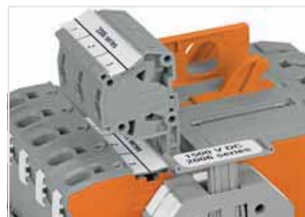
В качестве альтернативы измерение также может выполняться с использованием клемм TOPJOB® S (2006-511) от клеммы 1 к 2. Пустые модули (2006-549) следует использовать для компенсации ширины клеммы 15 мм.
