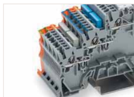
Объединение заземления: Для клемм датчиков и исполнительных устройств с заземлением на DIN-рейку соединение на землю может выполняться путём объединения с клеммой с заземляющей ножкой.
