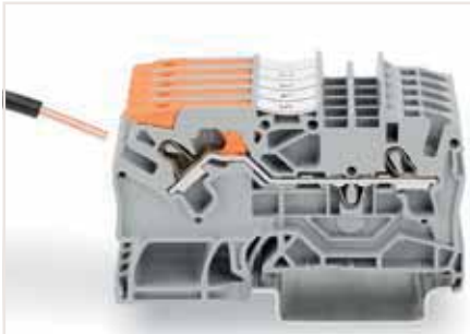
Подключение однопроволочных проводников путём простой вставки в клемму
