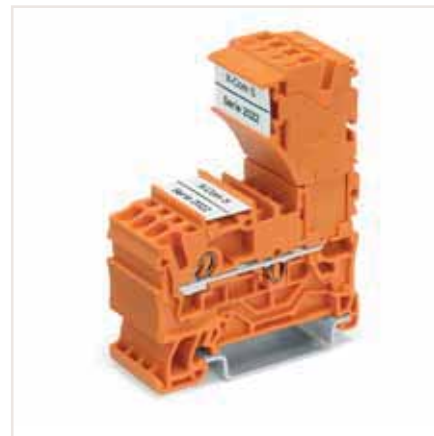
Вставьте кодирующий штифт в соответствующий разъём, поверните и отломите его.
