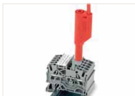
Адаптер тестового штекера (2009-174, категория I) для съёмных модулей 4 мм Ø, совместимый с сериями с 2000 по 2016
