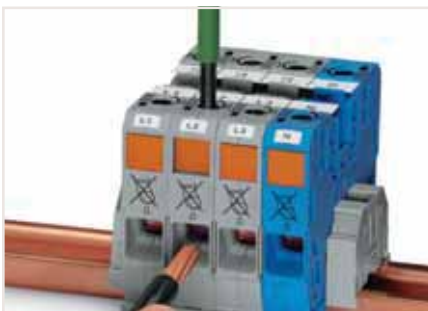
Подключение проводника – шаг 2 Введите зачищенный проводник в зажимное устройство до упора. Удерживайте его в этом положении.
