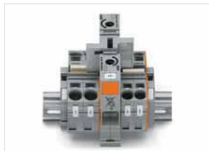
Объединение клемм 35 мм 2 (2 AWG) POWER CAGE CLAMP с клеммами 10/16 мм 2 (8/6 AWG) серий 2010 и 2016 TOPJOB® S с использованием ступенчатых перемычек (не подходит для 2016-76xx и 2016-77xx).
