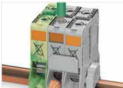
Подключение проводника – шаг 2 Введите зачищенный проводник в зажимное устройство до упора. Удерживайте его в этом положении.
