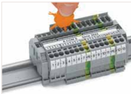
Вставьте кодирующий штифт в соответствующий разъём, поверните и отломите его.
