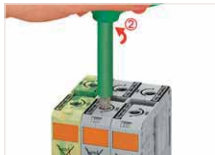
Подключение проводника – шаг 3 Короткий поворот против часовой стрелки разблокирует фиксатор. После разблокировки T-образный ключ вращается по часовой стрелке и надёжно зажимает проводник.
