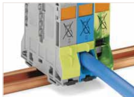
Жёлтые съёмные защитные ограждения обеспечивают защиту от касания, закрывая гнезда перемычек и (или) неиспользуемые вводы проводников.
