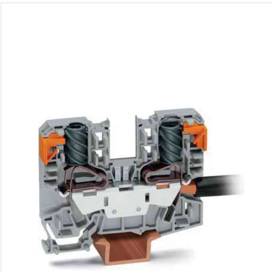
Подключение проводника – шаг 3 Небольшой поворот против часовой стрелки закроет зажим, зафиксировав проводник. После разблокировки поверните инструмент по часовой стрелке для надёжного зажима проводника.
