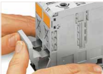
Объединение с соседней перемычкой: вставьте перемычку над отверстием ввода проводника перед его зажатием. Номинальное сечение остаётся неизменным.
