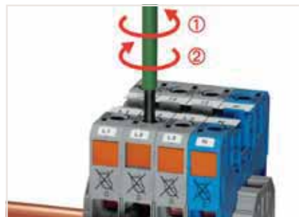
Подключение проводника – шаг 3 Небольшой поворот против часовой стрелки закроет зажим, зафиксировав проводник. После разблокировки поверните инструмент по часовой стрелке для надёжного зажима проводника.
