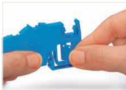
Установка разделительной пластины в держатель шины для защиты шины нейтрали от случайного касания.
