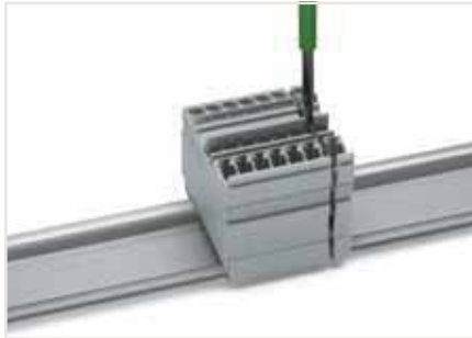
Откройте сборку, сдвинув крайние клеммы с помощью рабочего инструмента (лезвие 3,5 x 0,5 мм).
