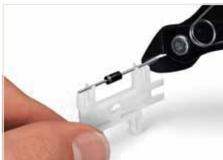
Обрезка компонента до необходимой длины.
