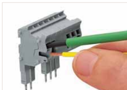
Подключение проводника с помощью: Рабочий инструмент для тонкопроволочных проводников без наконечников Зажим Push-in для однопроволочных проводников
