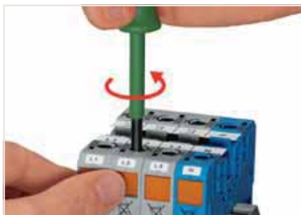
Подключение проводника – шаг 1 Поверните рабочий инструмент (ширина лезвия 5,5 мм) против часовой стрелки. Затем нажмите оранжевый рычаг. Зажим фиксируется в открытом положении, при этом руки остаются свободными для монтажа проводника.
