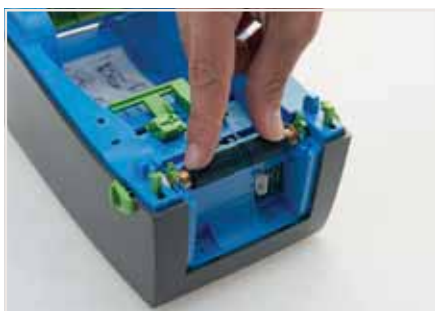
Вставьте подходящий валик в принтер и зафиксируйте его.
