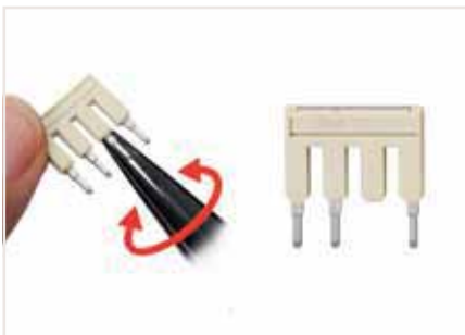
Специальные перемычки создаются путём отламывания и удаления контактов (серии 2000, 2001, 2002, 2004)
