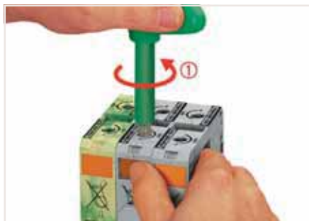
Подключение проводника – шаг 1 Вращайте T-образный ключ против часовой стрелки до упора! Затем нажмите оранжевый рычаг. Зажим фиксируется в открытом положении, при этом руки остаются свободными для монтажа проводника.
