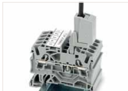
Тестовый отвод (2009-182) для присоединения тестовых кабелей без использования инструментов до 2,5 мм² (12 AWG) – совместим с сериями с 2000 по 2016
