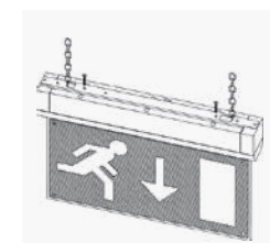
Потолочное крепление на цепь (гибкий подвес ST 50) В комплекте 2 цепочки с карабинами: 0,3 м (артикул – 2501002440) 0,5 м (артикул – 2501002450) 1,0 м (артикул – 2501002460) 1,5 м (артикул – 2501002170)
