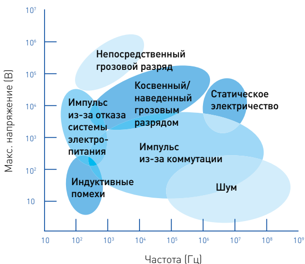
Рис. 1 Различные источники импульсов перенапряжения Импульсы перенапряжения от грозовых разрядов и от коммутации
