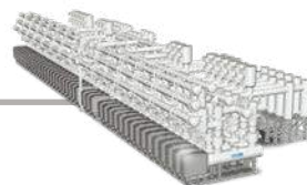
КРУ с газовой изоляцией
