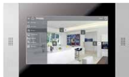
U.motion, сенсорная панель 15 дюймов
