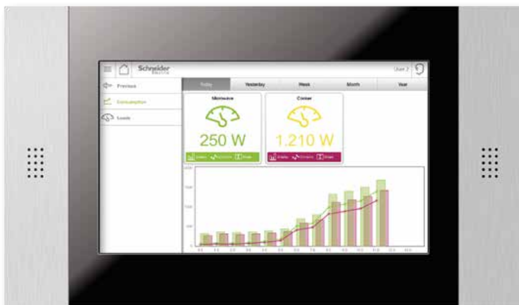
U.motion сенсорная панель 10 Визуализация параметров потребления электроэнергии
