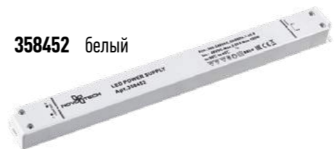
IP 20 Драйвер Пластиковый корпус Выходная мощность: 100 Вт Выходное напряжение: 48 В Входное напряжение: 200–240 В (Д*Ш*В) 320,6*30*18,2 мм
