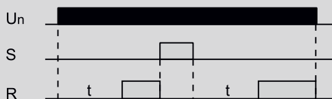
Диаграмма работы реле задержки включения ORT-A
